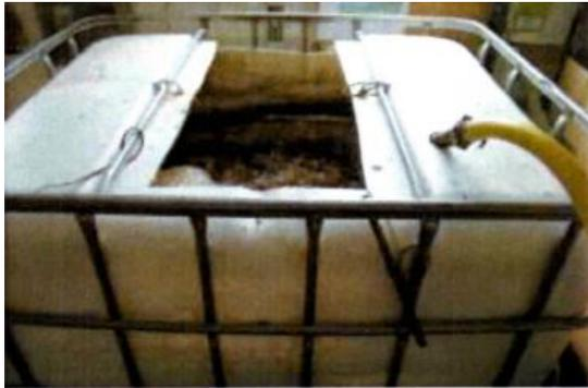
Als Ausströmer dient ein Bewässerungsschlauch (25 mm) mit gebohrten Löchern.
