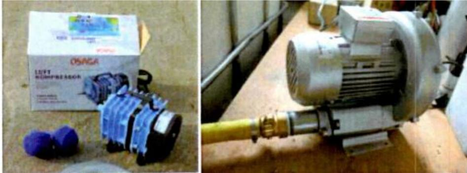
Aquariumpumpe für kleinere Behälter und Seitenkanalverdichter für IBC-Container
